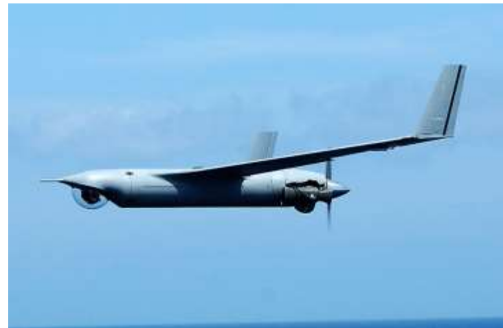
Boeing ScanEagle (lengte 1.5m, spanwijdte 3.1m) Marine
