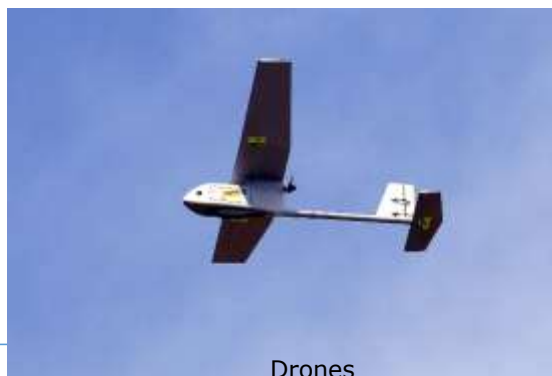
AeroVironment RQ-11 Raven (lengte 0.9m, spanwijdte 1.4m) Landmacht
